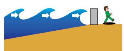
津波と高さが同じでも、波浪は波長が 長いため一つ一つの波により加わる力は 小さく沿岸で砕け散る。
