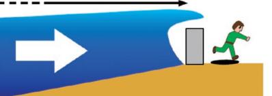
巨大な水の壁となって長時間力が加わる 津波は、陸上のものを破壊しながら 内陸まで一気に浸水する。
